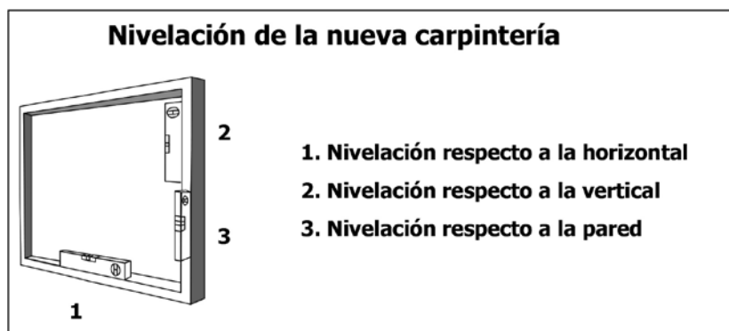
Figura 14. Nivelación de la nueva carpintería
