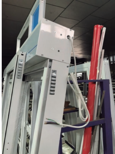
Figura 72. Salida del cableado del motor
