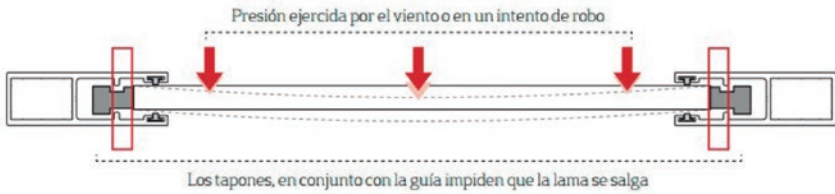
Figura 76. Sección horizontal de una lama y guías en sistema de alta seguridad, mostrando los tapones empotrados en la guía.
