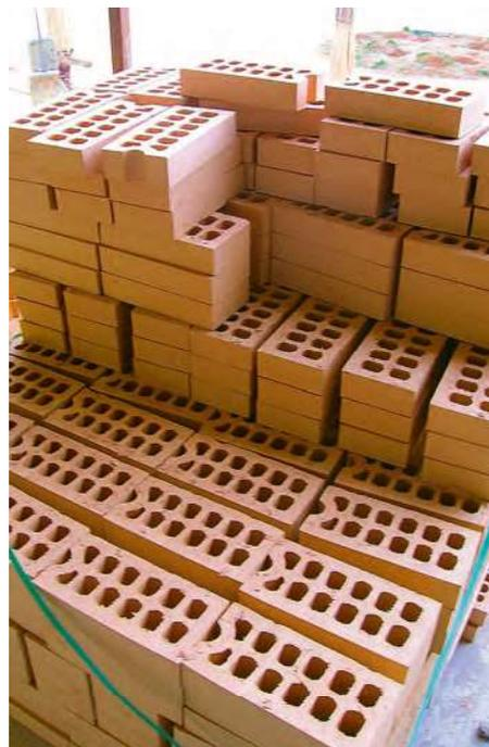
Figura 8: acopio en planta de ladrillos cara vista antes de ser colocados.
