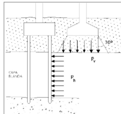
Figura 6: Empujes horizontales producidos por cargas superficiales
