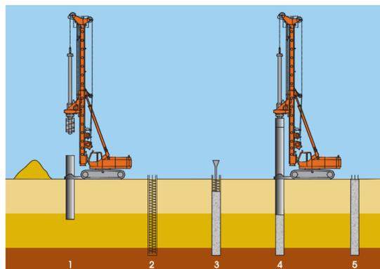
Figura 3: Pilote de extracción con entubación recuperable
