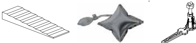
Figura 14. Cuña, bolsa de regulación y tornillo regulable
