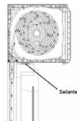
Figura 56. Detalle de unión de carpintería a cajón de persiana indicando posición del sellante
